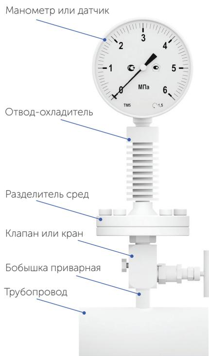
⚠ При монтаже вращать прибор разрешается только за штуцер с помощью гаечного ключа. Прикладывать усилие к корпусу прибора запрещается.
