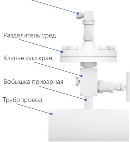
Манометр или датчик
