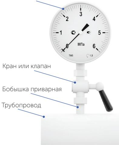
Датчик или манометр
